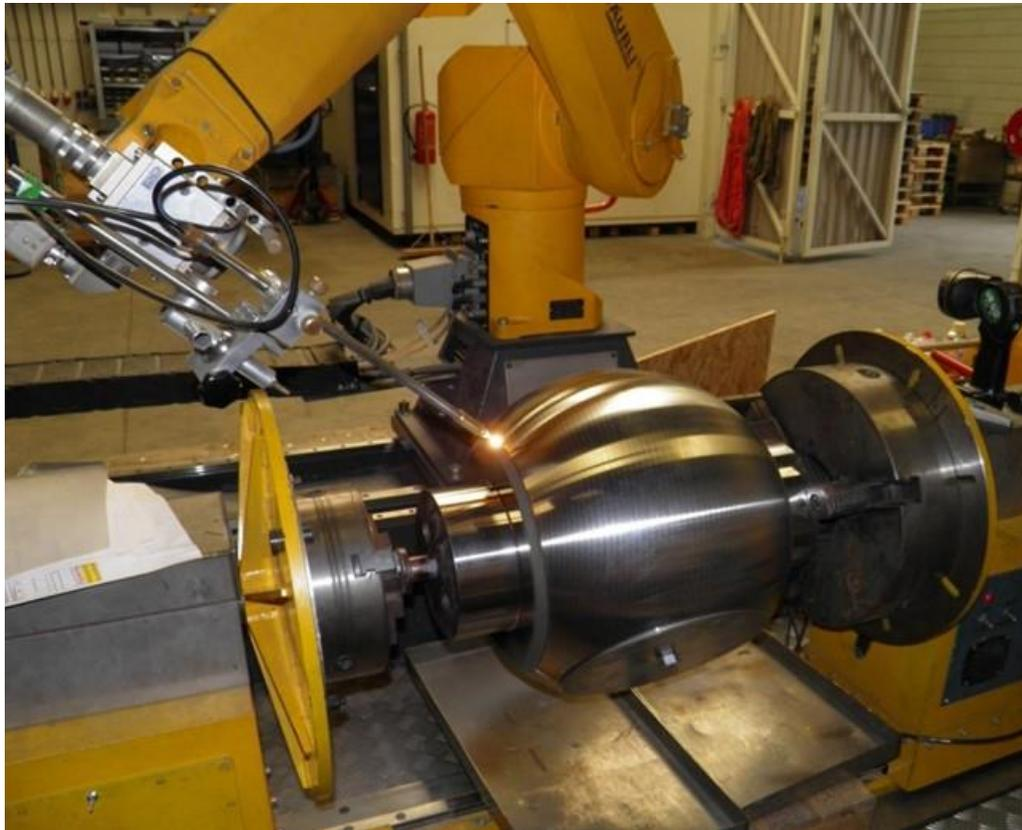
**Vorbearbeitete Kugel in der Aufspannung beim Laserbeschichten**
