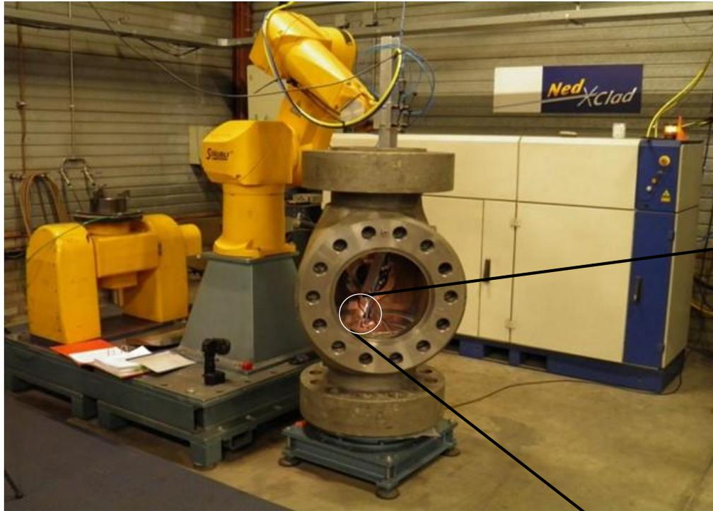
**Aufspannung des Bauteils auf dem Drehtisch**
