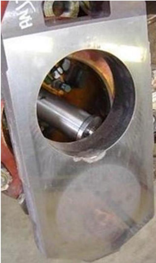
**Spatenschieber nach der beidseitigen Laserbeschichtung**
